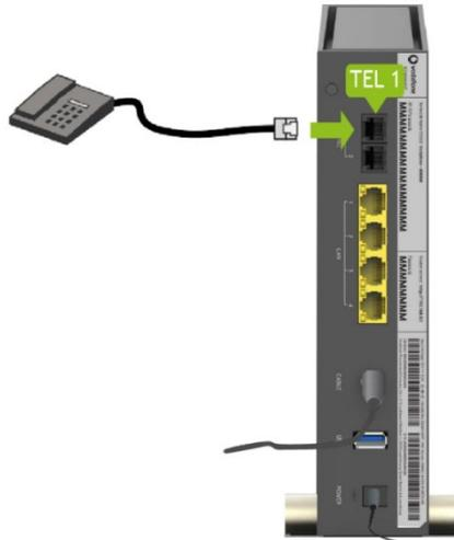
Schließen Sie das kabelgebundene Telefon, die DECT-Basisstation oder das Faxgerät an einen der **TEL**-Anschlüsse am CGA6444VF an.
